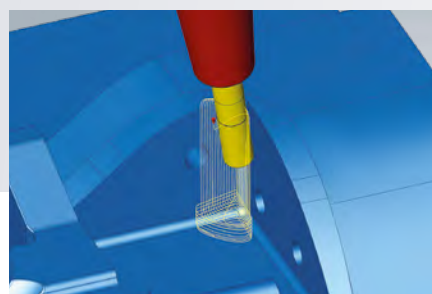
5 軸コーナー削り残り部加工による効率的な角部の加工
