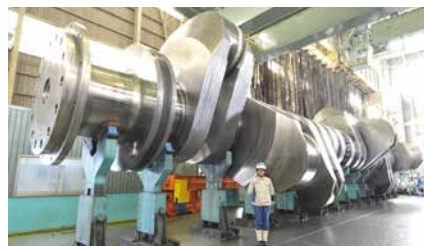
船舶用の超大型「組立型クランク軸」。
